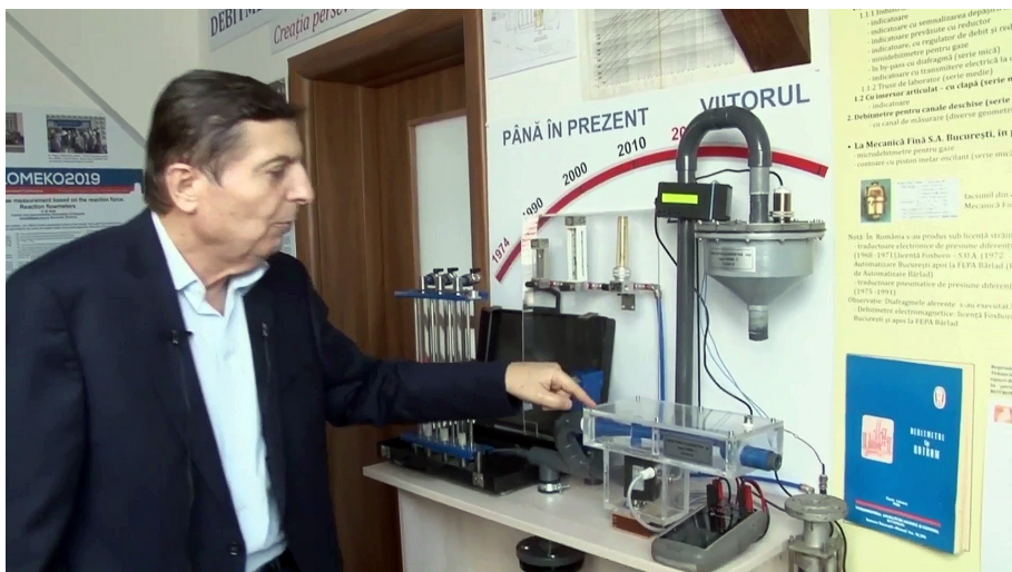
Explicând, în cadrul aceleiași expoziții, funcționarea prototipurilor Debitmetrelor cu reacție (fără piese în mișcare, respectiv cu piese în mișcare), realizate în premiera mondială.
